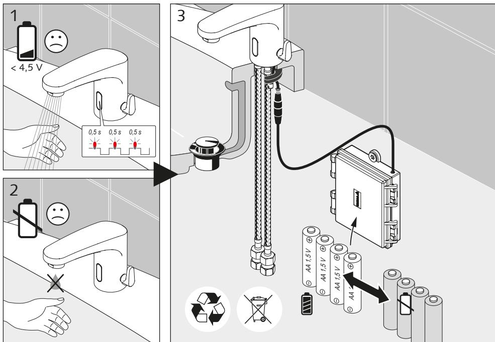
**DE** Not-Aus Funktion bei zu geringer Spannung
