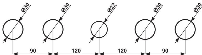
După pregătirea căzii, așezați piesele bateriei în orificiile realizate și fixați la părțile filetate laterale cu piulițele corespunzătoare
