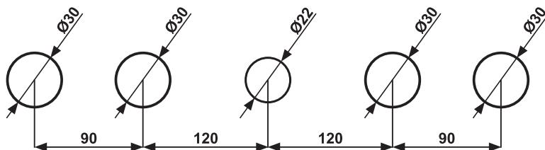
A kádtest előkészítése után helyezze a csaptelep alkatrészeket a kialakított furatokba és rögzítse a megfelelő anyákkal.
